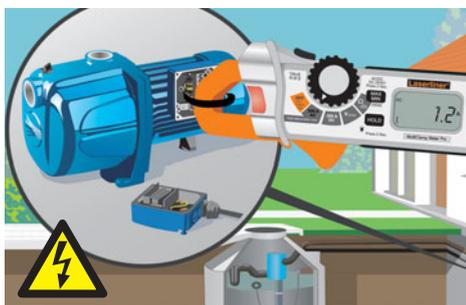
– **Medición rápida y segura en todos los circuitos de corriente cerrados**
