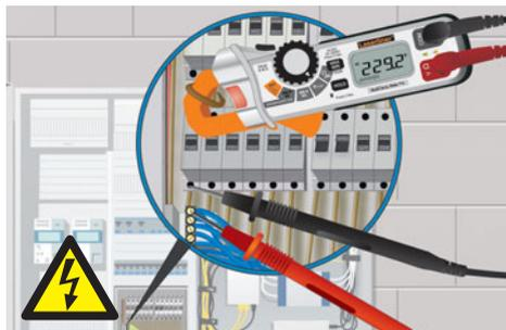
– Medición de corriente continua y alterna **con determinación real del valor efectivo (True RMS)**
