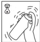
Agitar enérgicamente el aerosol durante 1 minuto después de que suenen las bolas mezcladoras en su interior. Pulverizar fuera de la zona de pintado hasta obtener una aplicación homogénea. Repetir frecuentemente durante la aplicación.
